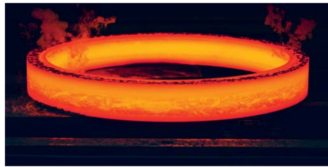
Im Edelstahlhammer- und Ringwalzwerk „Chr. Höver & Sohn“ werden unter anderem täglich rund 150 nahtlos gewalzte Ringe von klein bis groß produziert. Foto: Chr. Höver & Sohn GmbH & Co. KG / David Bock & Marc Michels
