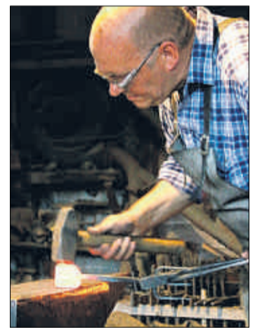
Schritt zwei. Mit Hammer und Amboss wird geschmiedet.
